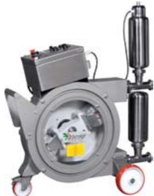
3) Pompa peristaltica (con e senza tramoggia di alimentazione), per un trasferimento soffice e delicato di uve intere, diraspate, fermentate e liquidi.
