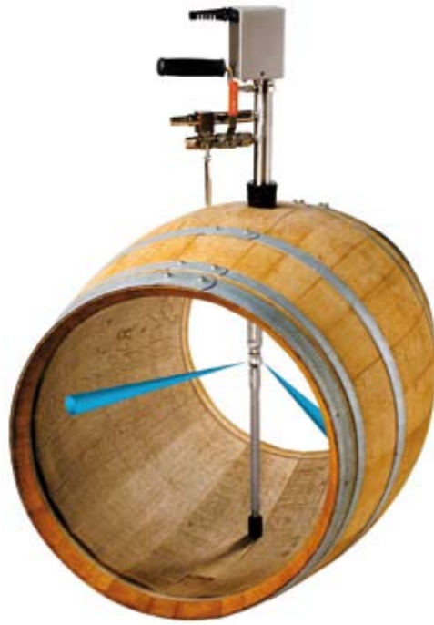
2) Testina di lavaggio a rotazione tridimensionale con due ugelli contrapposti in modo da raggiungere tutti gli angoli della barrique. Azionamento con motore elettrico.
