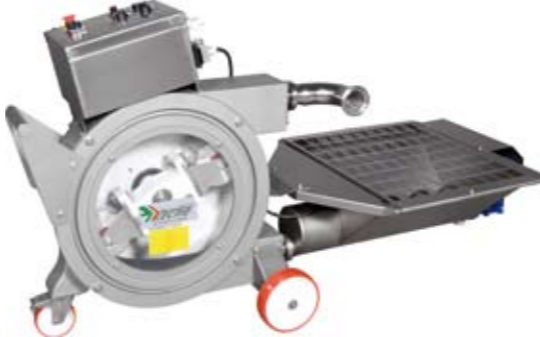
3) Pompa peristaltica (con e senza tramoggia di alimentazione), per un trasferimento soffice e delicato di uve intere, diraspate, fermentate e liquidi.
